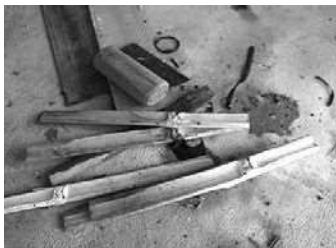
外皮を剥くのに使う道具 手前の竹のへらが大鹿で使われるもの 奥の金属製は昭和村で使われているもの
