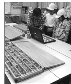
写真2 小学校のボーリングコアと村営水道の井戸掘削時の試料
