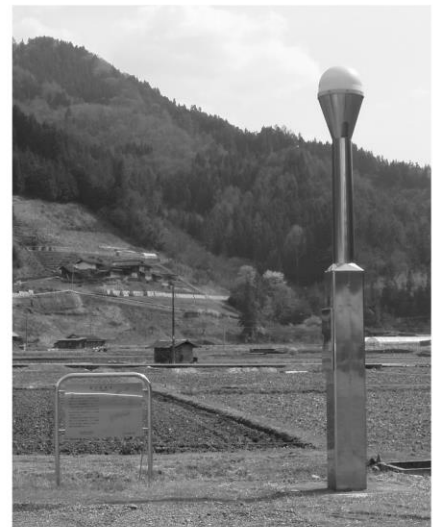
大鹿村中央構造線博物館構内の GNSS(GPS)電子基準点
