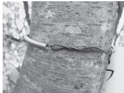
写真3 幹が太くなっ ても食い込ま ないように、 ばねを利用
